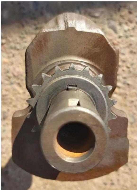
**INC.6:** Se debe reemplazar el piñón variador del leva de admisión, por un piñón fijo sin regulación, además se debe rectificar la cara solo del leva de admisión para efecto de instalación y correcta posición del piñón fijo y cadena. Los piñones de admisión y escape del leva serán provistos por la organización y llevarán un número de serie.
