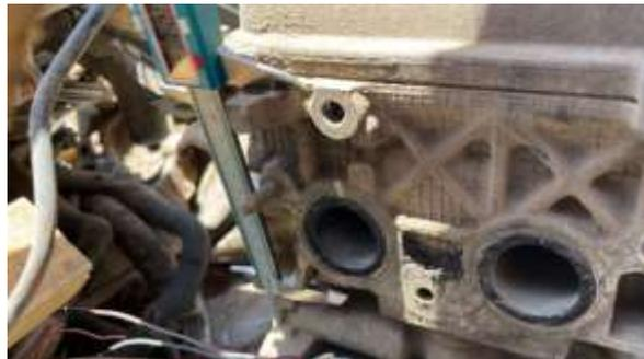
La medida podrá ser tomada sin desmontar la culata, y será en su parte posterior, del lado de escape del cilindro 4 (lado piloto), de la forma que se indica, si existe alguna diferencia de medición, se solicitará al piloto sacar su culata para efectuar la respectiva medición afuera. Todas las mediciones se harán con el mismo pie de metro.
