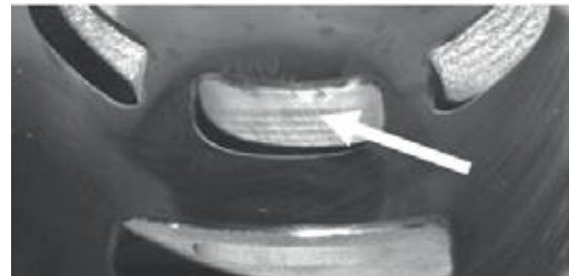
Cilindro de núcleo simple: superficie de acabado de fundición estructurada lineal
